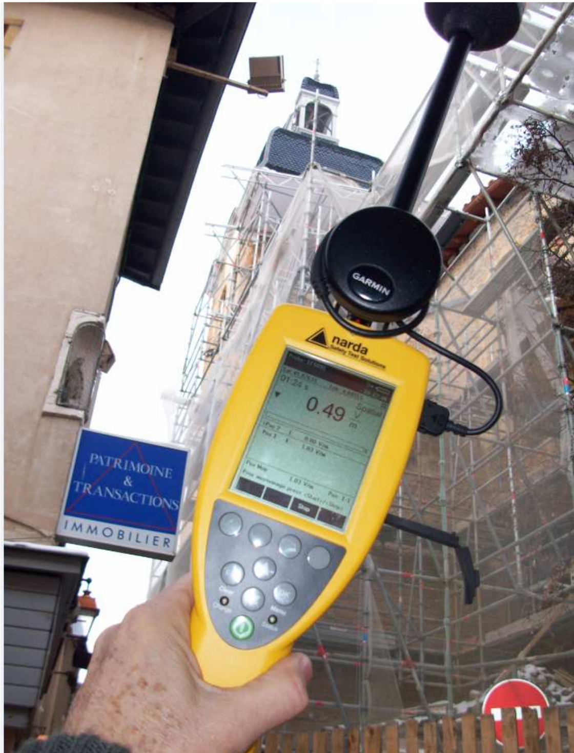
Eglise a vue des antennes WiFi 0,49 V/m
