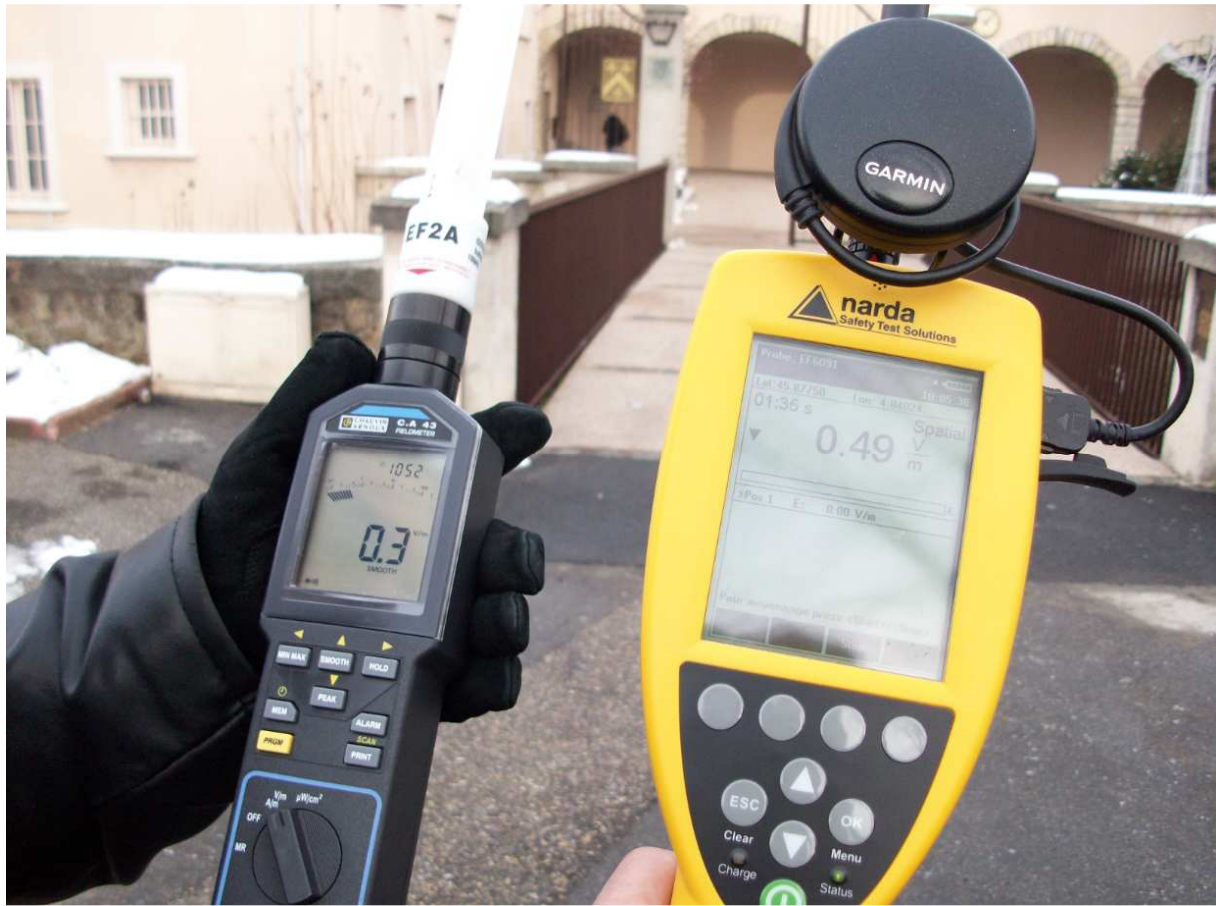
Entrée Mairie à vue des antennes 0,49 V/m
