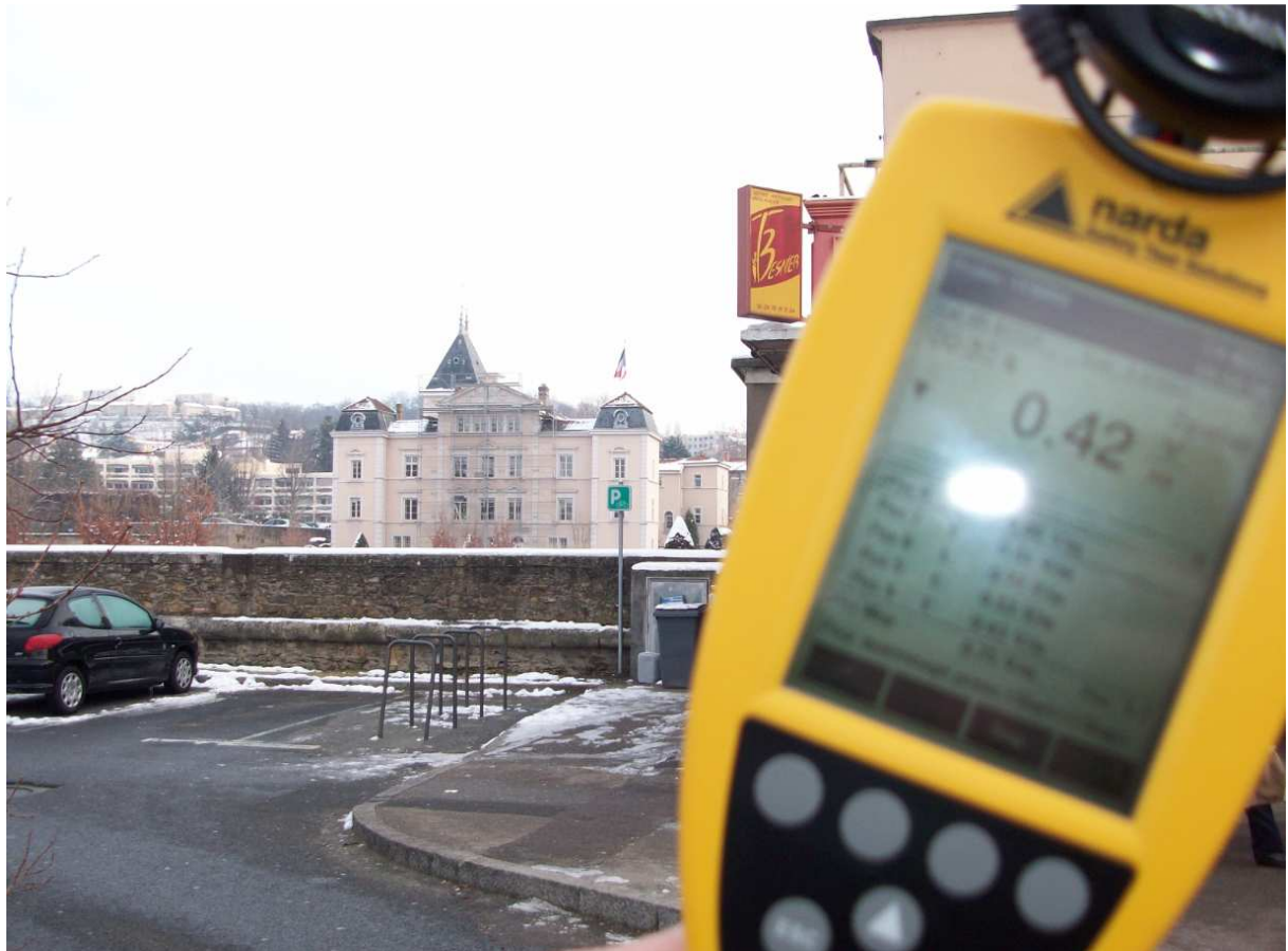
Place de Verdun a vue et à 650 mètres des antennes relais 0,42 V/m
