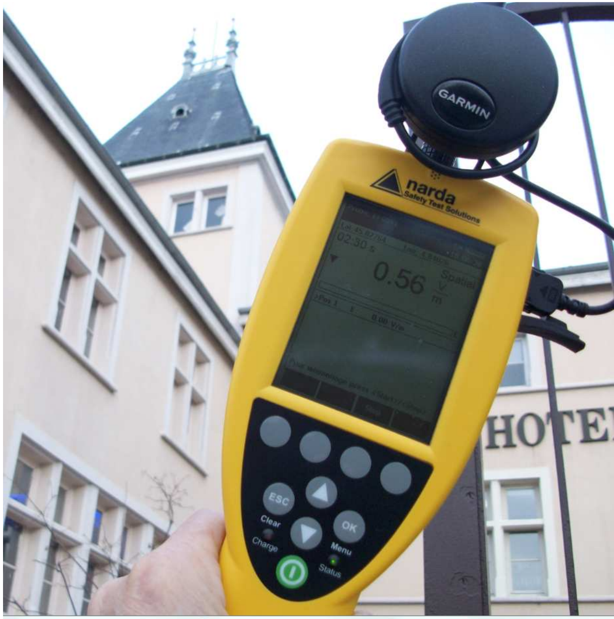
Cour de la Marie a vue des antennes WiFi 5.4 GHz 0,56 V/m
