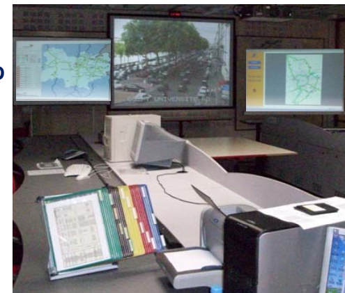
Les sorties LAN des Dominos alimentent le réseau du CIC, le CORG, La Préfecture et les écrans PC-TV
