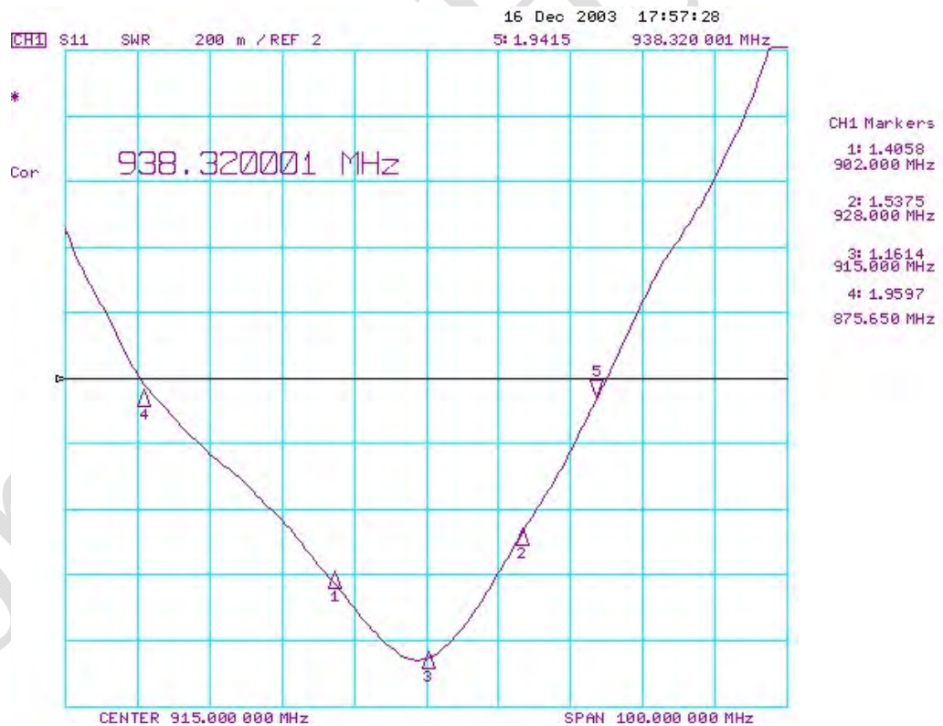
Adaptation ROS et centrage sur la bande allouée
