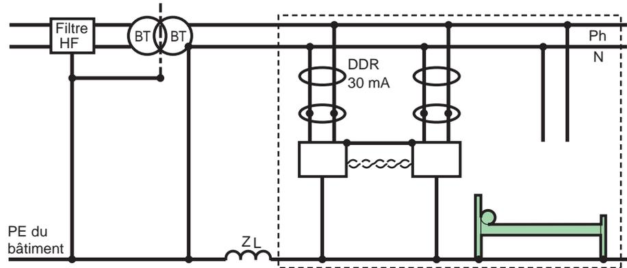
**Fig. 21** : alimentation d'un local exempt de perturbations électromagnétiques.
