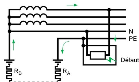
Fig. 19 : schéma TT.
