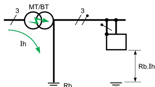
**Fig. 1** : risques liés à un claquage MT-BT dans le transformateur.
