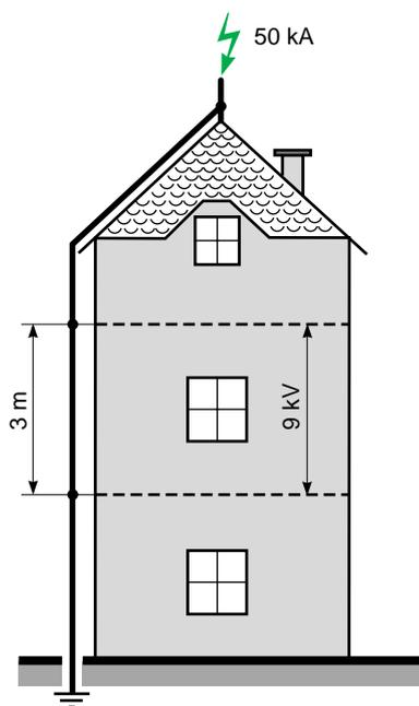
**Fig. 8 :** tension « de mode commun » générée entre 2 étages par un courant de foudre de 50 kA.
