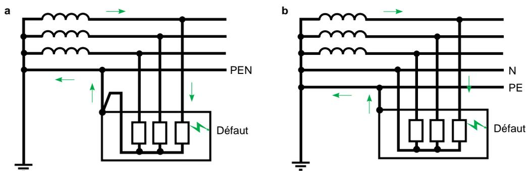
Fig. 18 : schémas TN-C -a- et TN-S -b-.
