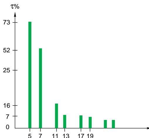
**Fig. 3** : exemples de spectres harmoniques de récepteurs.
