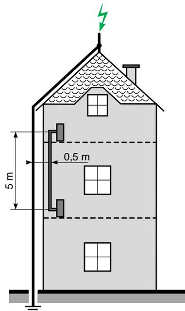
**Fig. 10** : le couplage inductif crée des tensions de mode différentiel dans les liaisons courant faible.
