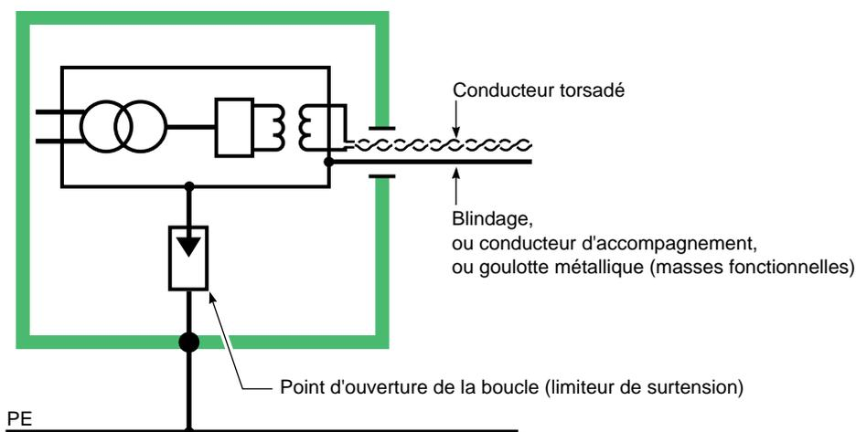
**Fig. 15** : exemple de dispositions prises pour éviter les perturbations par effet de boucle en HF.
